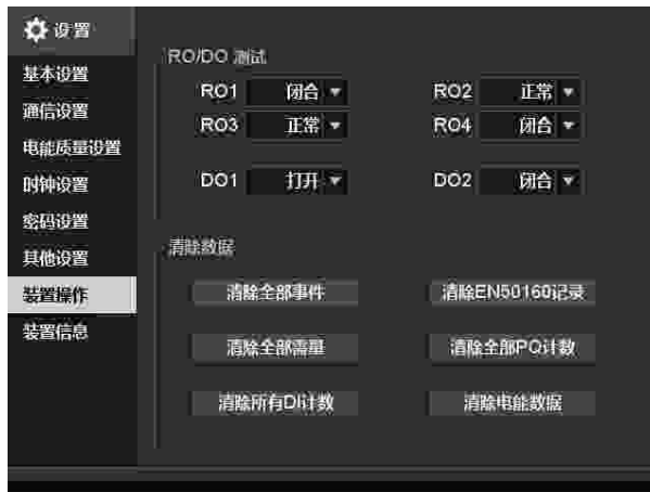
图 4-46 RO/DO 和清除操作界面
